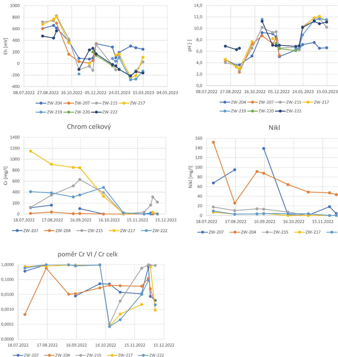
Obr. 3: Reakce prostředí a změny v koncentraci sledovaných látek v reakci na sanační zásah
