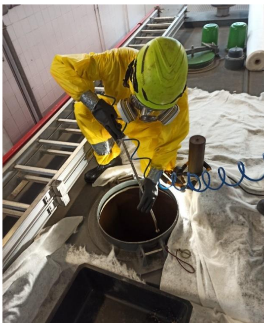
Obr. 3: Dekontaminace zásobní nádrže hasičského zásahového vozidla
