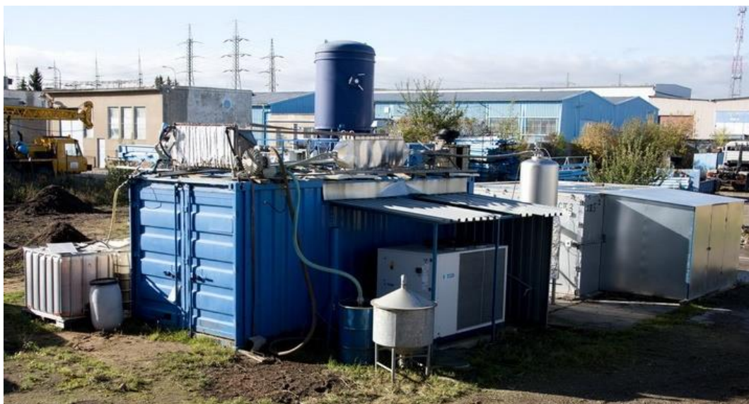
Obr. 2: Pilotní testování technologie on-site termické desorpce
