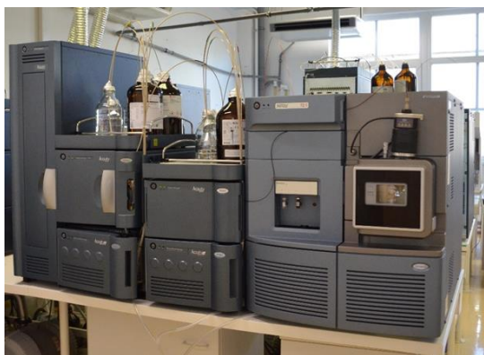
Obr. 1: Příklad instrumentu se speciálními úpravami pro analýzu PFAS (PEEKové kapiláry, column izolater)
